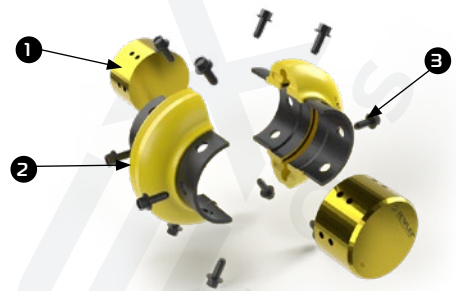
1 Cubo AW / AVS SAE 1045 2 Elemento AVV POLIURETANO 3 Parafuso AW / AVS AUTOTRAVANTE
