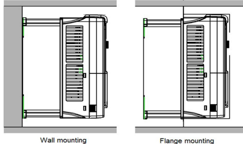
Fig 4-2 Forma de Instalação
